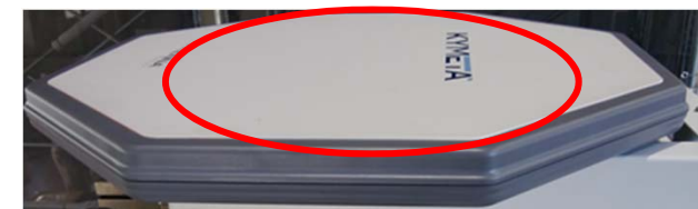
平面アンテナ部（通信衛星の自動追尾が可能）
