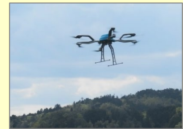
風速20m/s程度の荒天下でも 安定した飛行を確認
